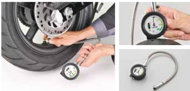
3色に色分けされた目盛りで高低判断ができるので測定が簡単!ヘッド部とホース根本の2か所が回転可動するので、作業しやすくなっています。
