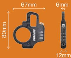
幅12mm(取り付け必要幅13mm)のスリムなヘルメットロック。ロック部は縦方向にスライドするので、コントロールスイッチ横など、左右のスペースが無いせまいスキマでも取り付けできます。フック部もスリムなので、ヘルメットのDリングを引っ掛けやすく、ロック部をオープン状態にしないと取り付けボルトを回せないで、防犯性に優れます。
