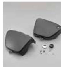
W1SA以降のオイルタンクをモチーフにしたFRP製黒ゲル仕上げのサイドカバー。ダミーのオイルタンクキャップ、サイドカバーノブも付属し、当時の雰囲気を実際に再現しています。ノーマルの丸みを帯びたサイドカバーと付け替えるだけで、車体のイメージがガラリと変わります。ノーマルエアクリナー対応。左右1セット。
